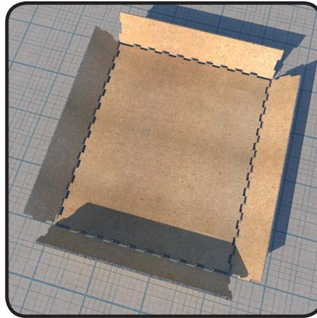
Рис 2. Даже если в «распашонка» нет маркировки деталей, то сборка не должна у вас вызвать сложностей. Склеивать детали надо именно так, как они положены на лист. Верхнюю деталь к верхнему краю дна, правую к правому, нижнюю к нижнему и левую к левому.
